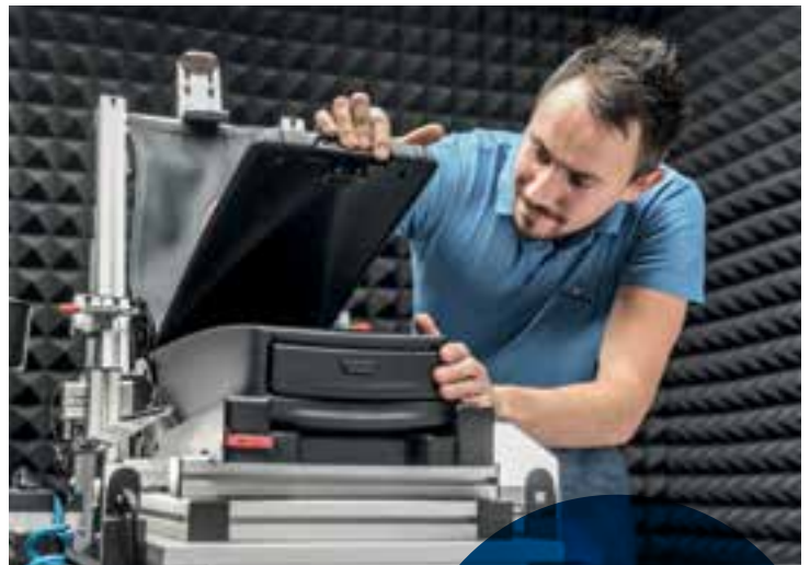
In einem schalldichten Raum testet ein Mitarbeiter das Klappverhalten einer Mittelkonsole.
